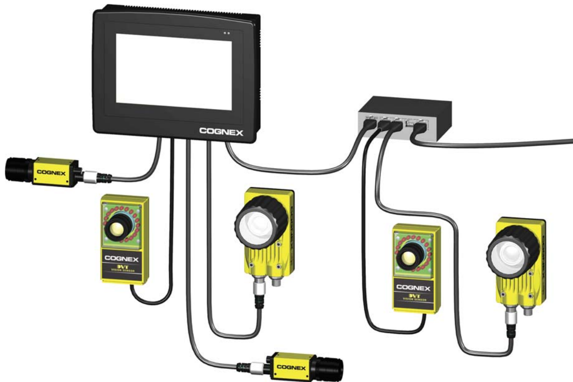
Figure 2-4 : VisionView connecté au réseau d'usine
