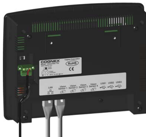
Figure 2-5 : Connexion du câble d'alimentation
