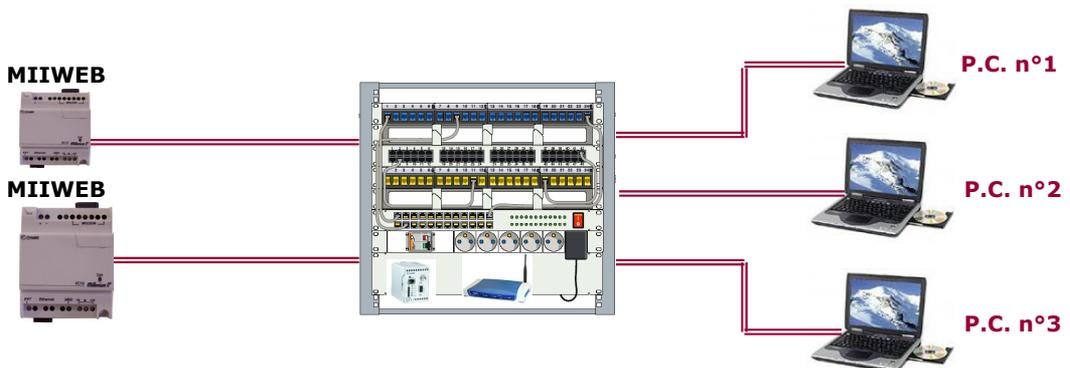
L'armoire de commande doit être sous tension, le connecteur RJ45 du MIIWEB est relié au réseau Ethernet (vers SWITCH de l'armoire de brassage) par l'intermédiaire d'un câble informatique non croisé (4 paires catégorie 5 FTP minimum).
