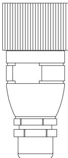
**Achtung:** Die Nummerierung des Anschlußsteckers kann von Hersteller zu Hersteller in der Reihenfolge unterschiedlich sein. Wird ein Stecker mit einer anderen Reihenfolge angeschlossen, so muß dies unter Berücksichtigung der dargestellten Anschlußbelegung geschehen. Die Lage der Stifte muß mit der Funktion am Gerät übereinstimmen. In diesem Handbuch wurde ein Stecker der Binder Serie 623 verwendet.
