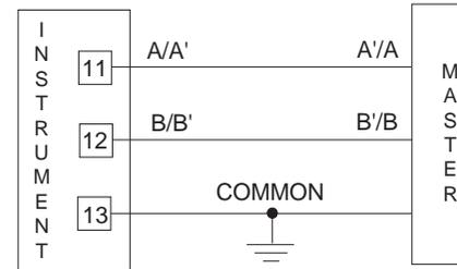
Fig. 10 - RACCORDEMENT DE LA LIAISON NUMERIQUE RS-485
