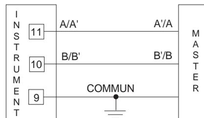
Fig. 12- RACCORDEMENT DE LA LIAISON NUMERIQUE RS-485
