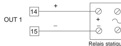
Fig. 11 RACCORDEMENT POUR LE PILOTAGE DU RELAIS A ETAT STATIQUE
