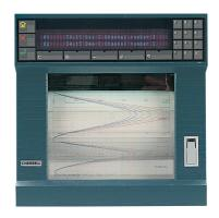
Le modèle 4180M est un enregistreur pointé 180 mm robuste et très performant. Jusqu'à 24 signaux de procédé peuvent être tracés sur le diagramme et stockés sur carte mémoire. Un afficheur alphanumérique haute résolution permet la visualisation simultanée de 4 voies. La combinaison de messages programmables, de fonctions mathématiques puissantes et de la liaison série confère au modèle 4181M une souplesse et un rapport qualité/prix inégalés pour l'acquisition et l'enregistrement de données.
