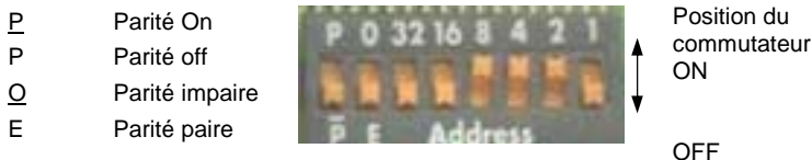
Figure 2-8 : commutateur d'adresses Modbus
