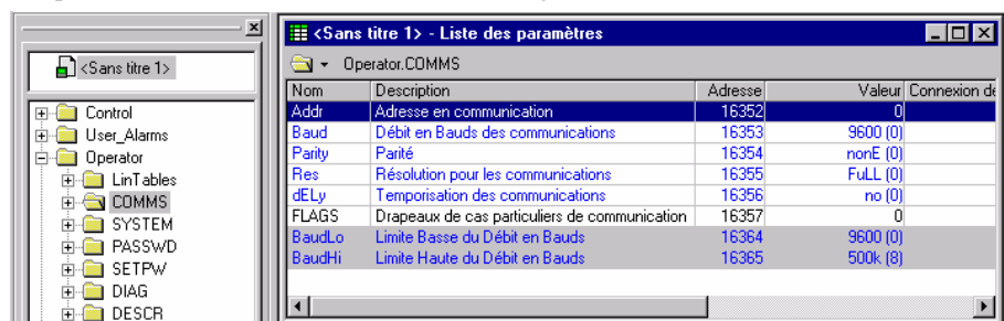
Figure 6-2: Paramètres de communications Modbus (niveau Configuration)
