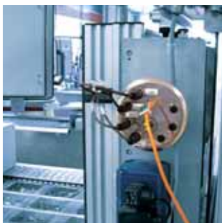
ProcessLine : module inox avec un haut indice de protection sur un doseur.
