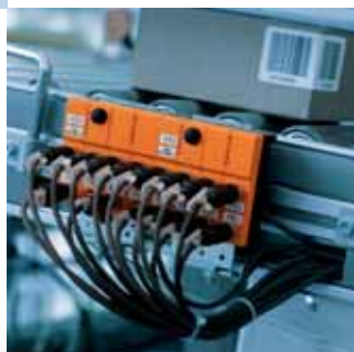
Montage sur rail DIN sans outils : module ClassicLine sur une ligne de convoyage.
