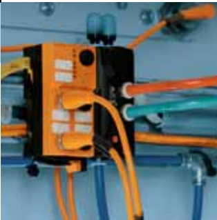
A un prix favorable : commande directe des vérins via AS-i AirBox.
