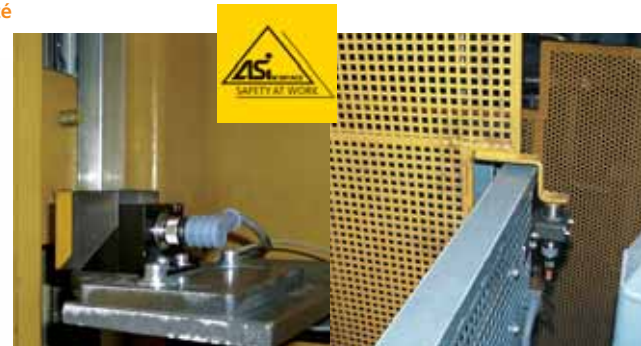
Détection sûre sans aimant ou cible codée. Le détecteur de sécurité inductif ifm surveille un portail coulissant d'une presse à métaux ou la position de portes vers la zone de sécurité.
