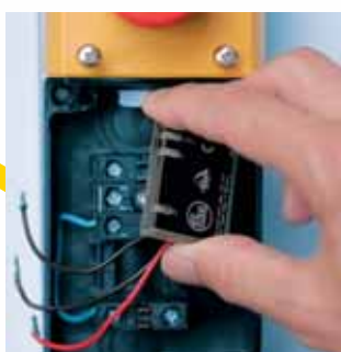
Circuit imprimé AS-i intégré dans une boîte à boutons.
