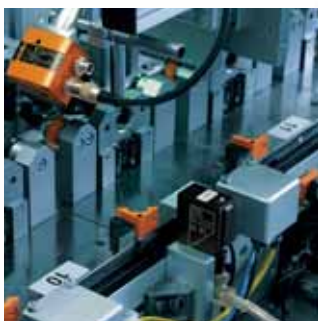
Le système RFID code et identifie les palettes d'une ligne de production.
