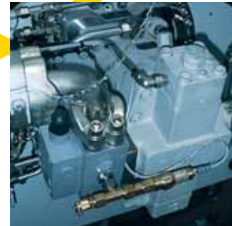
Capteurs de pression PPA avec une bonne protection contre les chocs et les surcharges.
