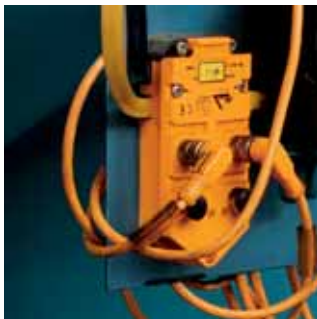
Modules de terrain robustes : boîtier compact grâce au surmoulage complet.
