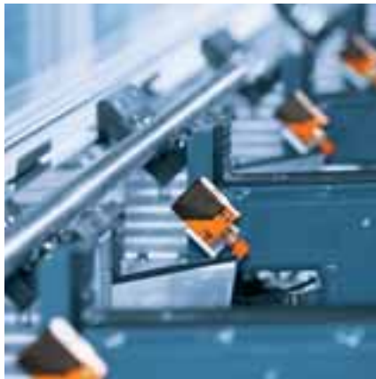
Les détecteurs inductifs parallélépipédiques IMC détectent la position d'une barre en acier pendant le chargement et le déchargement d'une machine.
