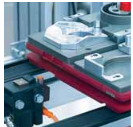
Le détecteur inductif détecte la position du support d'une pièce à usiner.
