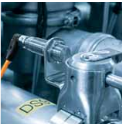
Un détecteur tout inox de la série T surveille la position de la vanne dans une brasserie.
