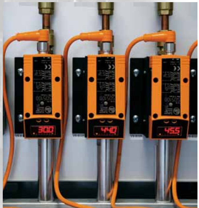
Mesure de la consommation d'argon dans un système de soudage laser.
