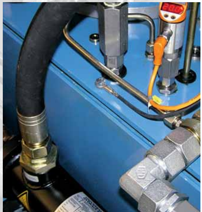
Sonde rigide avec boîtier électronique TR raccordé.
