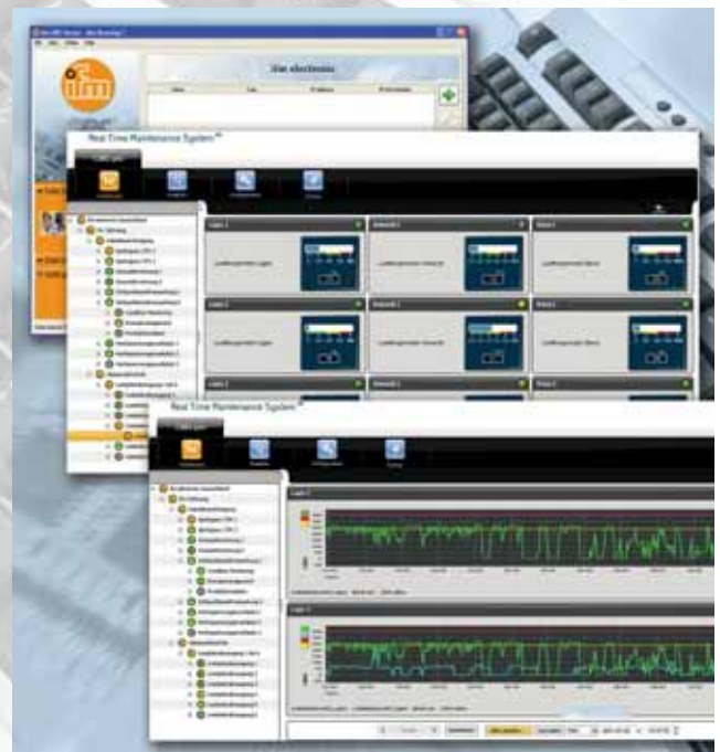
Exemple d'un logiciel de supervision à base d'OPC.
