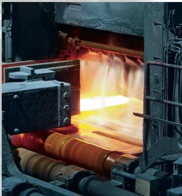
Détection de position de galettes d'acier dans un laminoir.
