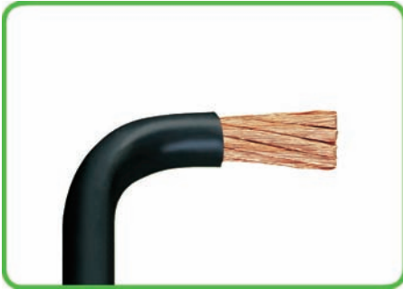
Plier le conducteur avant de le dénuder ! L'extrémité du conducteur doit être droite ! Attention : Longueur de dénudage 35 mm
