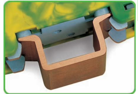
La pression de contact est distribuée de manière symétrique sur toutes les zones de contacts définies. Sécurité avec des courants de court-circuit de plus de 11,4 kA/1 sec.
