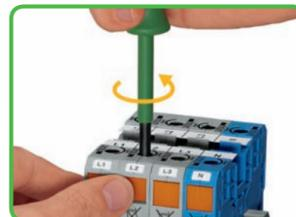
Tourner le tournevis (lame 5,5 mm) en sens inverse des aiguilles d'une montre. Enfoncer l'élément de blocage quand la cage à ressort est ouverte.
