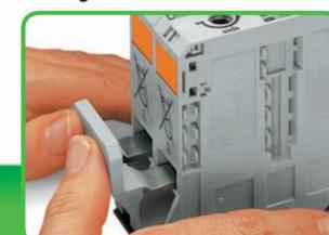
Pontage à l'aide des contacts de pontage horizontaux au-dessus de l'introduction du conducteur, sans aucun outil - à v a n t la connexion du conducteur. La section nominale de 50/95 mm<sup>2</sup> n'est pas modifiée.
