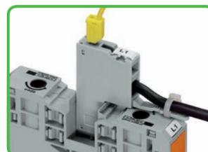
La borne de prélèvement de potentiel est montée dans la fente de pontage. Cette borne peut être équipée d'une plaque de décharge de traction et offre une possibilité de pontage pour les fiches de contrôle de Ø 2 mm / 2,3 mm.
