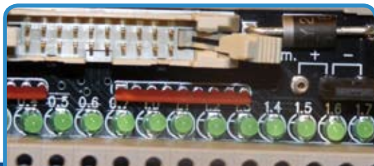
Visualisation d'état des voies par LED verte. Green LED for channel status indication.
